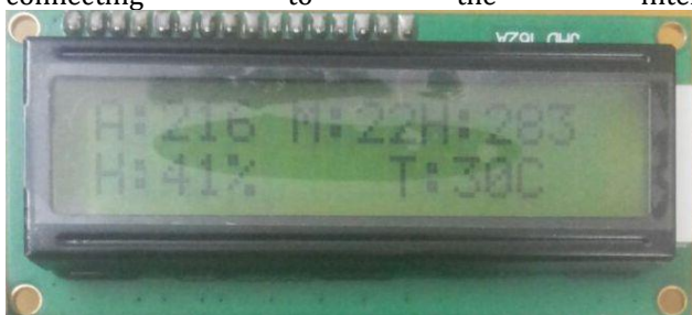
Fig 9. Sensor values displayed on LCD
