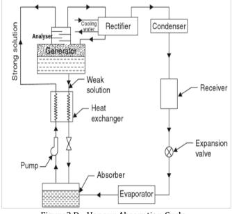
Figure2.D:- Vapour Absorption Cycle
