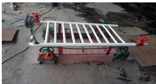
Fig: 3.7 Actual bagasse dryer
