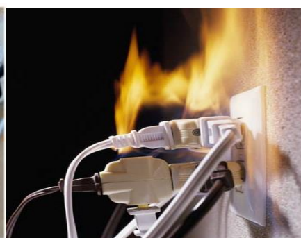
1-расм. Бир неча юқори қувватли (мўлжалланмаган) электр истеъмолчиларини бир тармоққа параллел улаш натижасидаги ортиқча юкланиш
