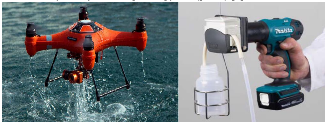
Рис.1 – Дистанционный отбор проб воды из жидких накопителей
