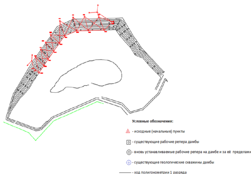
Рисунок 2. Схема расположения рабочих реперов, расположенных на дамбе и близлежащей территории, для проведения наблюдательных работ
