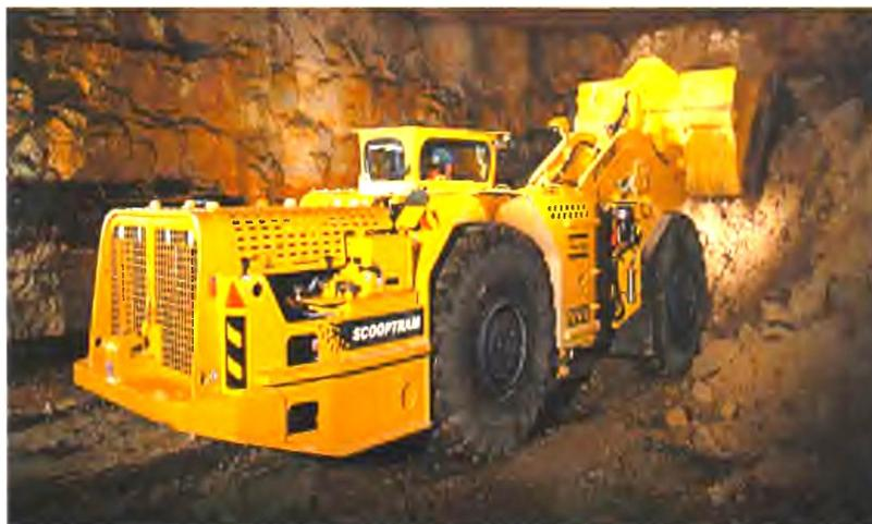
Рис-3. Погрузочно-доставочная машина в очистной выработке
