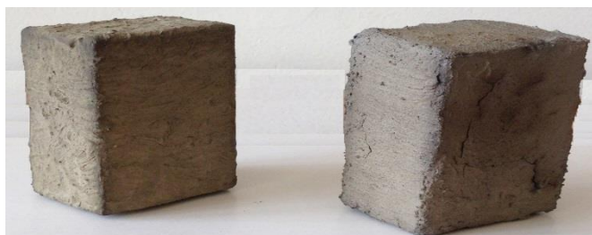
Рис. 2. Образец 3 (Проба № 3) до испытания (слева) и после нагрева в течение 120 с при 750°C (справа)
