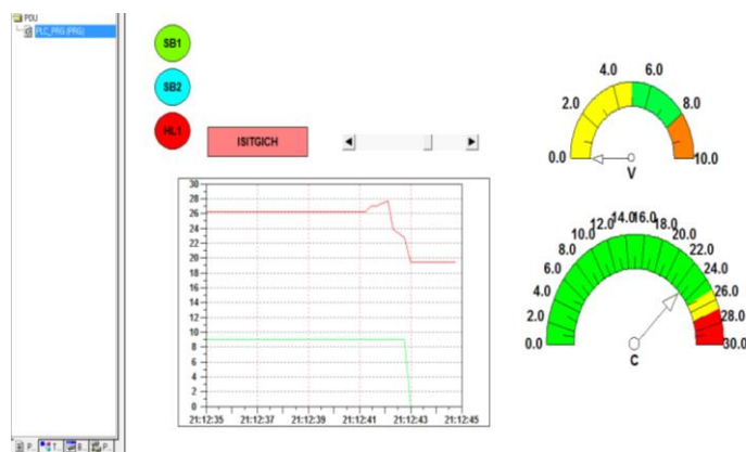
3 –rasm. CoDeSys kompleks dasturida issiqxonada harorat va ventilyatsiya tizimini nazorat qilishni visuallashtirish.
