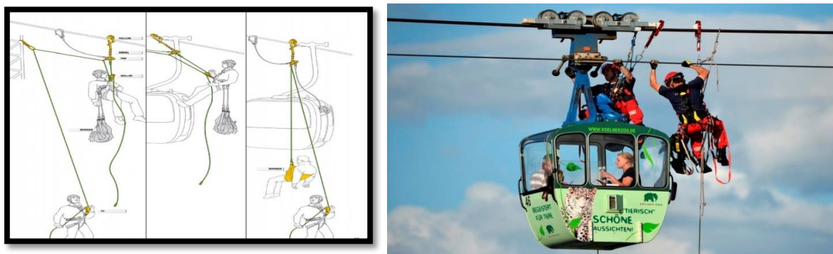
Рис.2.Спуск пострадавшего по системе «Petzl».
