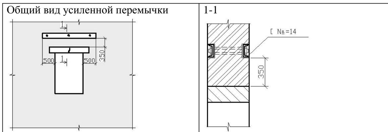
Рис. 4 – Усиление железобетонных перемычек с разломами.
