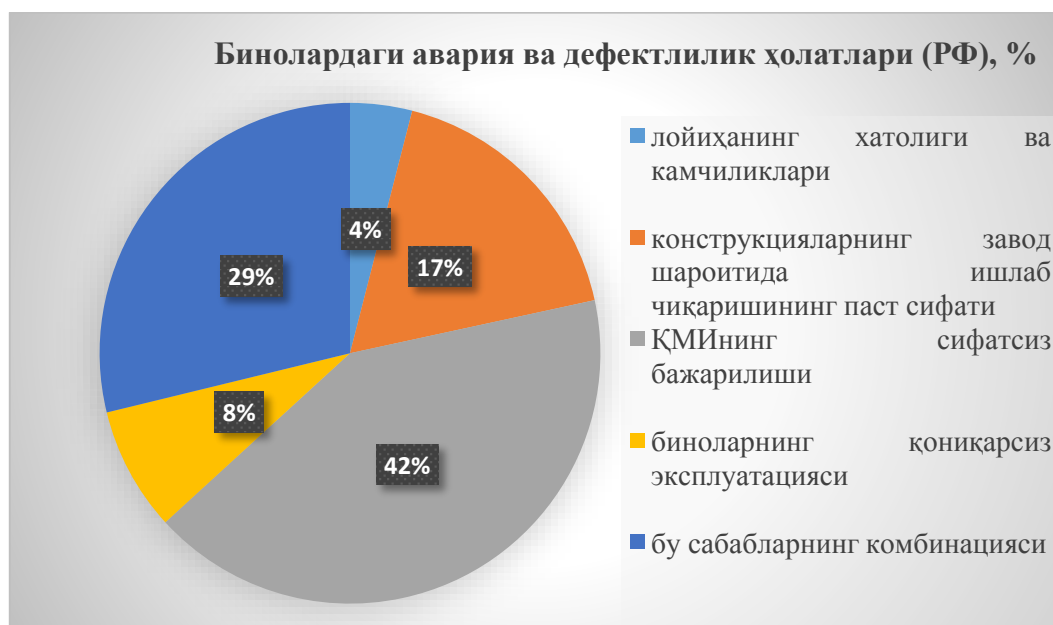
4-расм. Биноларда авариялар ва уларда нуқсонлар бўйича лойиҳалаш, қурилиш ва эксплуатация мобайнида ва уларнинг комбинациясидан пайдо бўладиган хатоликлар.
