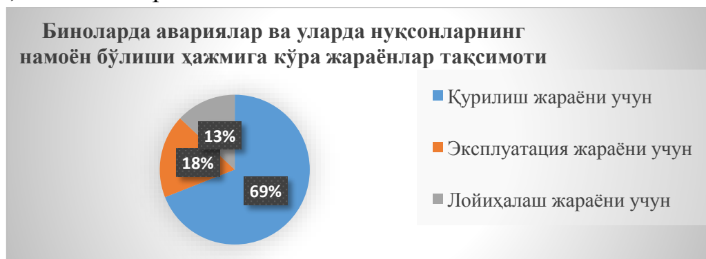
6-расм. Биноларда авариялар ва уларда нуқсонларнинг намоён бўлиши ҳажмига кўра жараёнлар тақсимоти.
