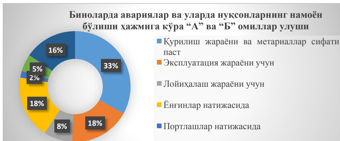
7-расм. Биоларда авариялар ва уларда нуқсонларнинг намоён бўлиши ҳажмига кўра “А” ва “Б” омиллар улуши
