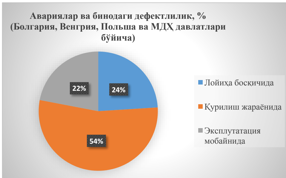
1-расм. Биноларда авариялар ва уларда нуқсонлар бўйича лойиҳалаш, қурилиш ва эксплуатация мобайнида йўл қўйиладиган хатоликлар
