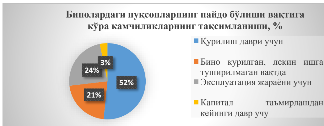
5-расм. Биноларда авариялар ва уларда нуқсонларнинг намоён бўлиши вақтига кўра камчиликларнинг тақсимланиши.
