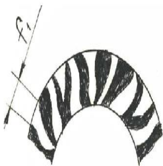
Шакл. 6. Тери эт қатлами юзасидан намликнинг буғланиш юзасини яримцилиндрик полка(токча)ларга гигроскопик материалга фиксациялаб(ёпиштириб) кўпайтириш схемаси.
